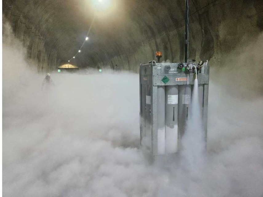
Kuva 3 Projektissa tutkitaan mm. erilaisten kaasujen käyttäytymistä tunneliolosuhteissa.
